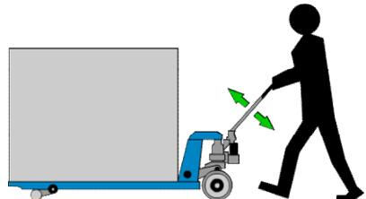
Груз поднимается при движении ручки гидравлической тележки.
